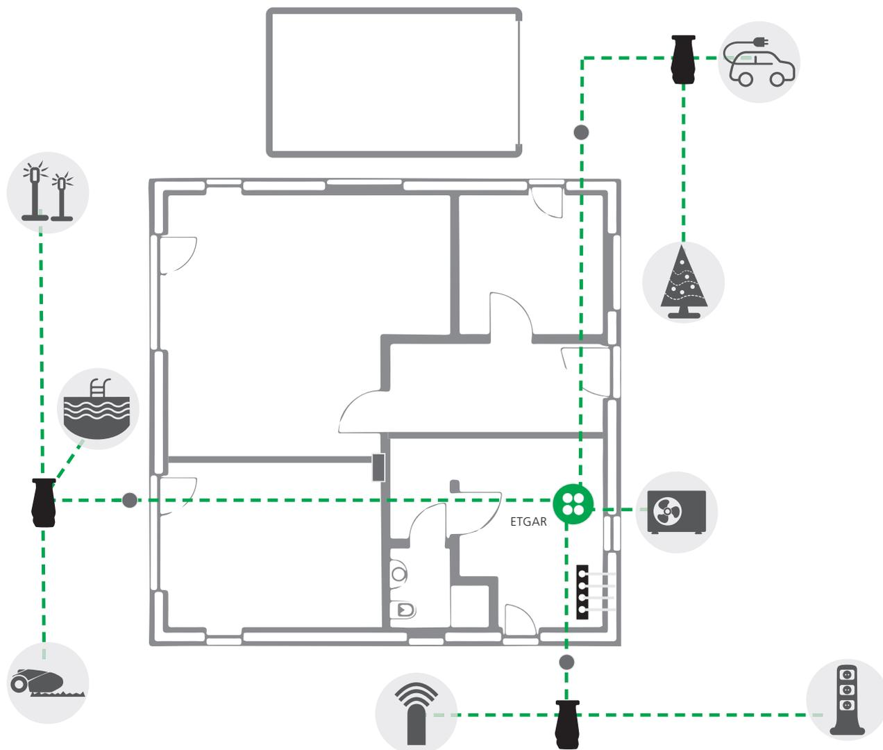
Ist das Haus einmal fertiggestellt, geht es irgendwann an die Außengestaltung des Grundstückes. Nun kann man die bereits während der Bauphase gesetzten Zugangspunkte einfach verlängern und an die gewünschte Stelle führen, nochmal abzweigen oder einfach blind verschlossen liegen lassen, um den Zugang irgendwann später nutzen zu können.
